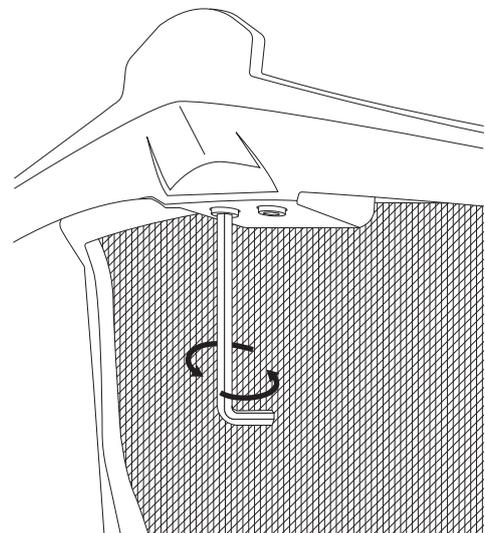
Colocar los tornillos (**pieza 3**) en la parte inferior y ajustarlos con la llave Allen (**pieza 4**) de manera vertical.
