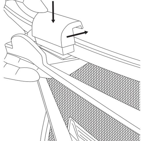
Una vez ubicado el perchero, colocar el soporte superior (**pieza 2**) haciéndolo encastrar. Hacer presión y sujetar.
